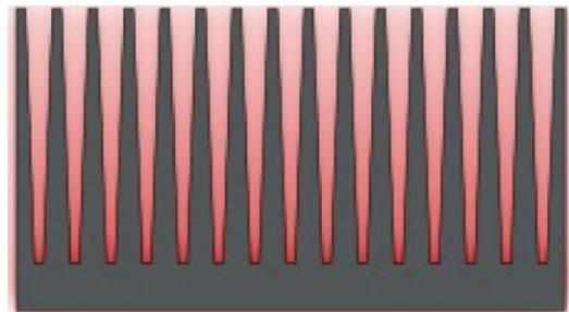
Cette disposition permet d'augmenter grandement la surface de contact entre l'air et le matériau et améliore ainsi le transfert thermique (qui est d'autant meilleur que la surface de contact entre les deux milieux est grande). En effet, la surface de contact entre l'air et le radiateur est plus importante que si ce dernier était tout à fait droit et rectiligne comme un simple parallélépipède par exemple:
