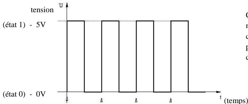
Chaque flèche sur la figure marque le début d'un cycle. Avec ce type d'horloge, la sortie est à 1 pendant la première moitié du cycle et à 0 pendant la seconde.
