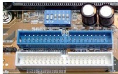
Les larges nappes branchées à ces connecteurs attirent la poussière et gênent la circulation de l'air à l'intérieur du boîtier. Les toutes dernières cartes mères n'en sont donc plus équipées, au profit des ports SATA qui permettent l'utilisation de câbles plus fins.
